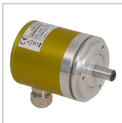
Przetwornik Kinax WT720, wejście 0-360 st., wyjście 4-20 mA, 24 V DC (2-przewodowe), średnica wałka 10 mm, 720-1111100000 GMC-720-1111-1000
